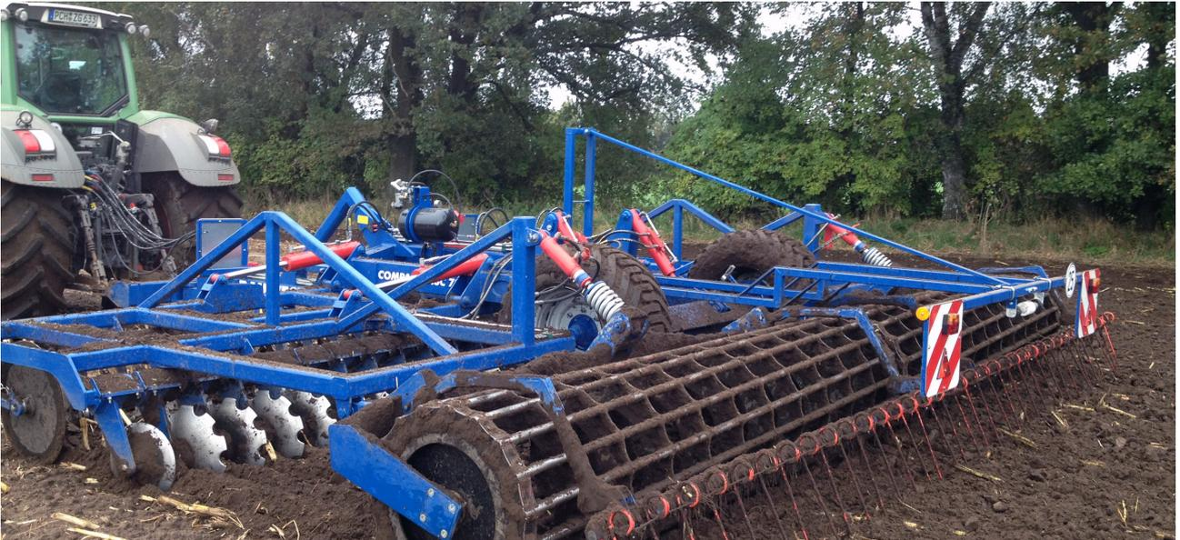
Die Profi-Kurzscheibenegge für die Stoppelbearbeitung und leichte Bodenbearbeitung
