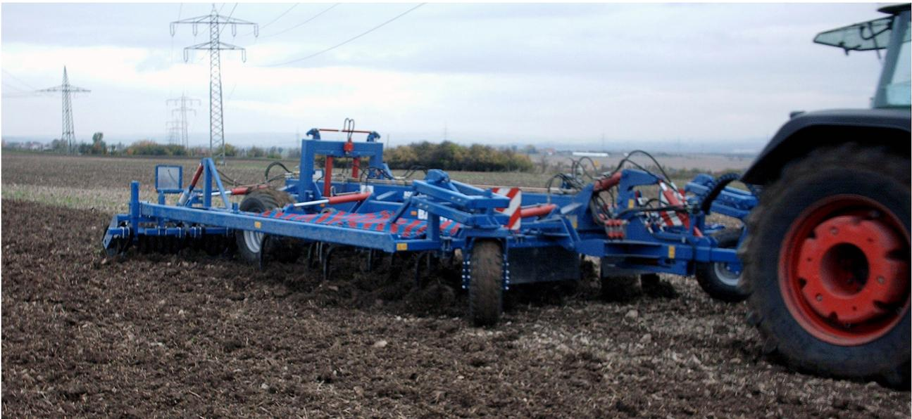
Der Profi-Grubber für die Stoppel- und Grundbodenbearbeitung
